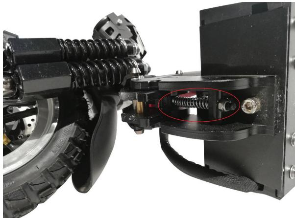
Cette vis contrôle aussi la résistance à la fermeture de la trottinette; si le levier de fermeture est trop dur, desserrer l'écrou.
