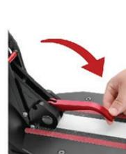
4. Tirez également le deuxième levier rabattable vers le bas jusqu'à ce que le mécanisme de verrouillage s'enclenche (vous entendrez un déclic).
