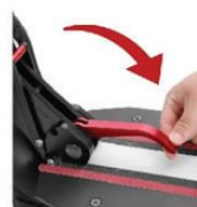
4. Tirare verso il basso anche la seconda leva di piegatura e continuare ad abbassare la barra del manubrio fino a quando si inserisce il meccanismo di blocco (si avverrà un clic).
